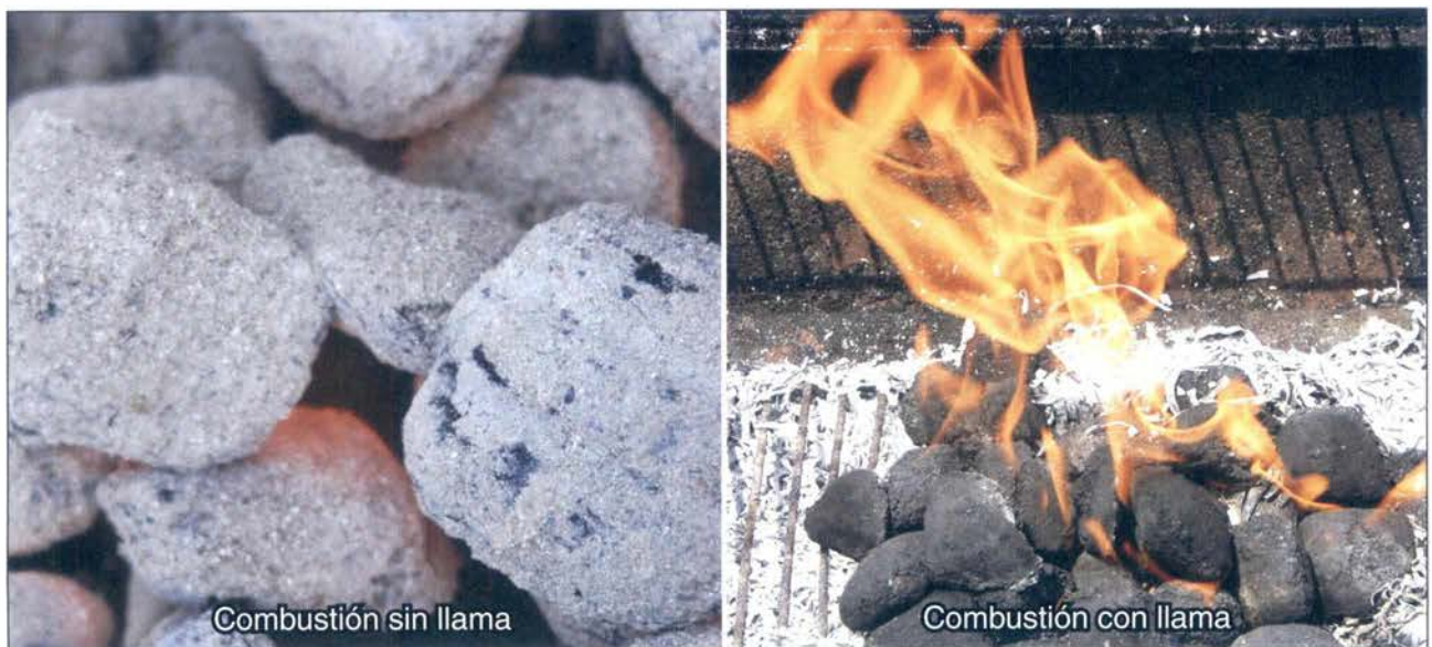
Imagen 4.8 La combustión sin llama (izquierda) presenta temperaturas más bajas. La combustión llameante (derecha) muestra llamas visibles sobre el combustible ardiendo.
