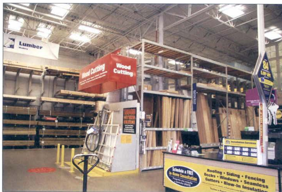
Imagen 4.55 Un ejemplo de una estructura comercial con plano de planta abierta y alta carga combustible.
