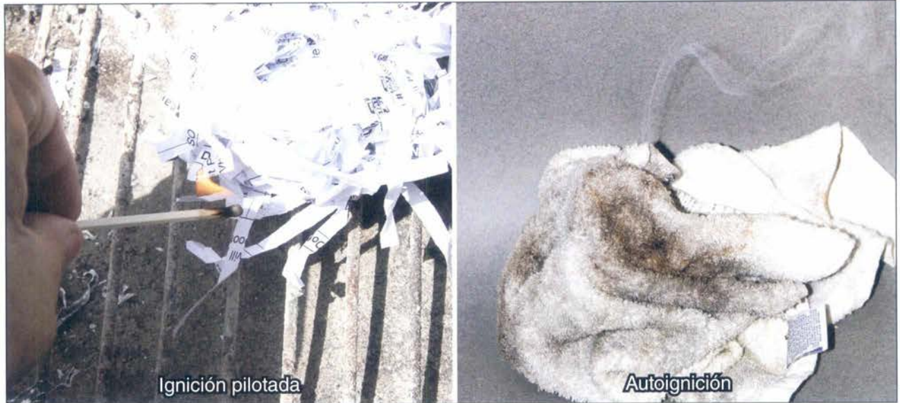
Imagen 4.7 La ignición pilotada (dirigida) implica la introducción de una fuente de ignición externa, mientras que la autoignición ocurre bajo condiciones especiales sin el calor de una chispa u otra fuente.
