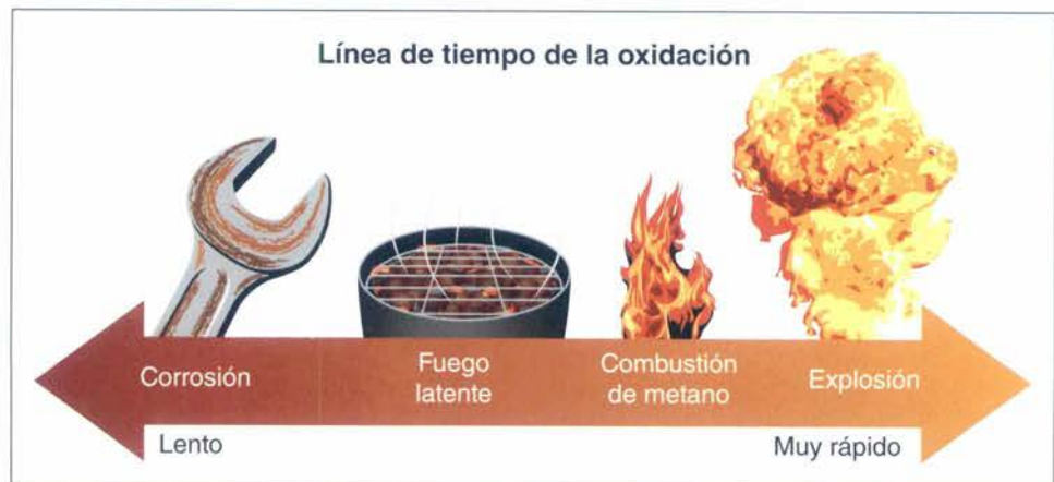
Imagen 4.2 La cronología de la oxidación ilustra las diferencias de velocidad entre cada tipo.
