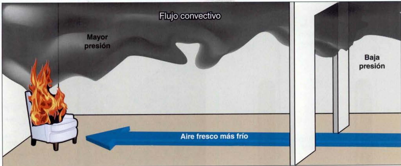
Imagen 4.11 Los gases calientes se desplazarán hacia arriba y hacia afuera de un fuego, mientras que el aire más frío se atraerá hacia el fuego creando un flujo convectivo.
