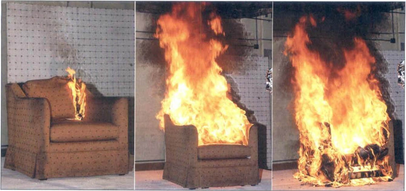
Imagen 4.51 Estas imágenes demuestran cómo la espuma de poliuretano de la silla hace pirólisis rápidamente en condiciones de fuego. Cortesía de Dan Madrzykowski, NIST.
