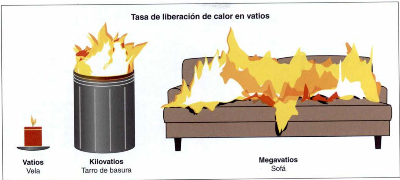
Imagen 4.21 Ejemplos de condiciones de tasa de liberación de calor que pueden medirse en vatios, kilovatios o megavatios.
