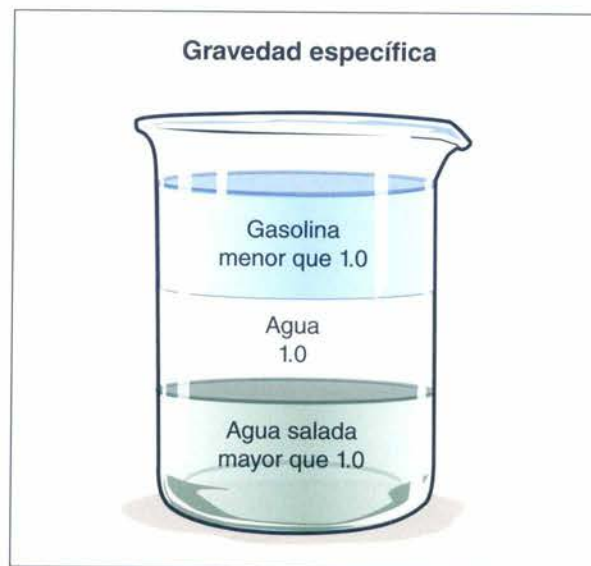
Imagen 4.23 La gravedad específica de un líquido indica si flotará en la superficie del agua o se hundirá.
