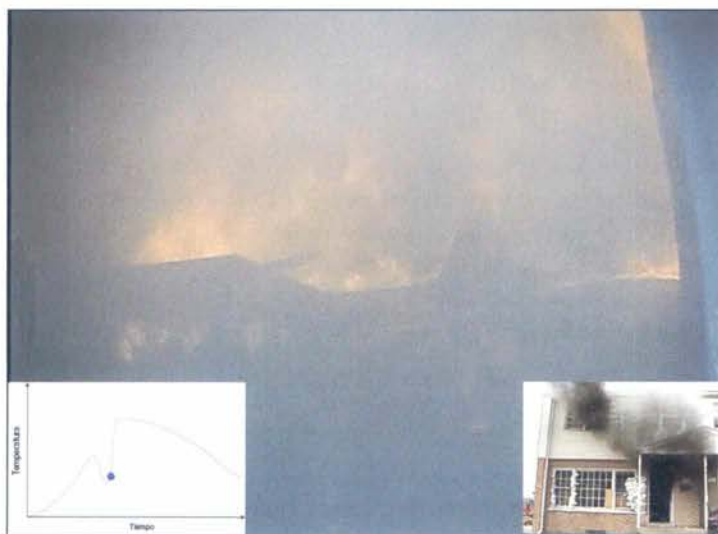
Imagen 4.42 En esta imagen, el fuego crece rápidamente a medida que se introduce oxígeno fresco en el compartimento. Cortesía de Dan Madrzykowski, NIST.
