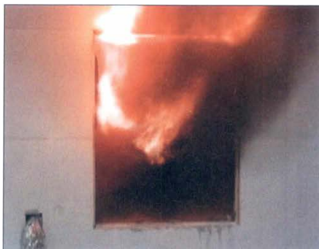
Imagen 4.49 La ventilación repentina de un incendio en un compartimento puede provocar un desarrollo rápido del fuego. Cortesía de Dan Madrzykowski, NIST.
