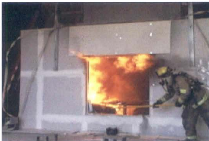
Imagen 4.37 Al romper la ventana, el bombero introduce nuevo oxígeno en el compartimento, lo que aumenta la tasa de liberación de calor y el crecimiento del fuego. Cortesía de Dan Madrzykowski, NIST.
