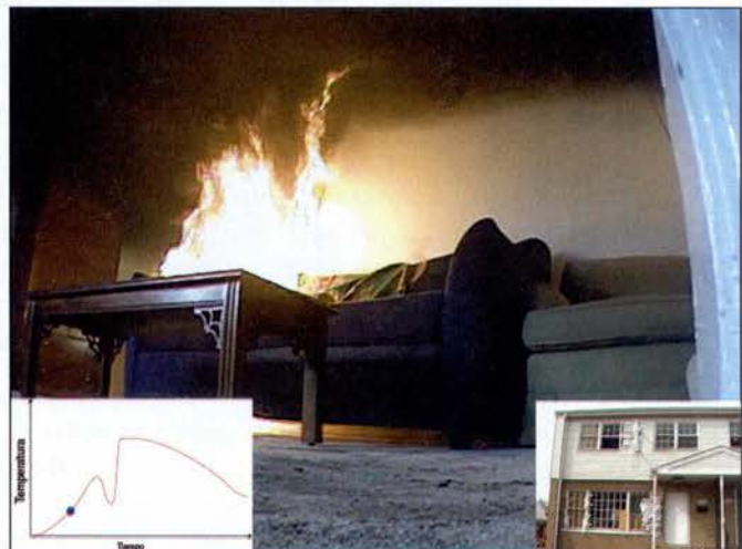
Imagen 4.33 El gráfico de esta imagen muestra la transición de un incendio desde la etapa incipiente a la etapa de crecimiento. Cortesía de Dan Madrzykowski, NIST.
