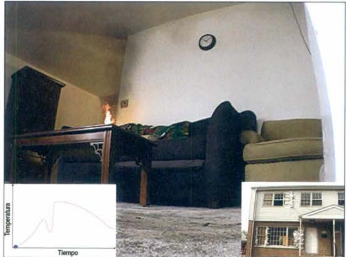
Imagen 4.31 El gráfico de la parte inferior izquierda muestra la progresión del incendio en su etapa incipiente. Cortesía de Dan Madrzykowski, NIST.
