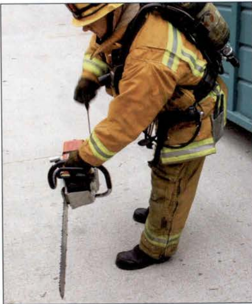
Imagen 11.25 Los equipos con fuente de poder deberían iniciarse en el suelo para asegurar su funcionamiento, pero apagarse antes de izarlos o transportarlos.
