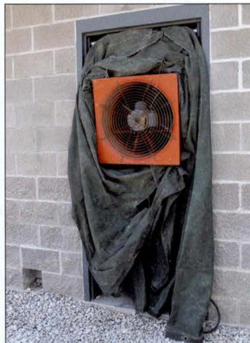
Imagen 11.17 Los eyectores de humo se utilizan para extraer los gases calientes del fuego y el humo de una estructura.
