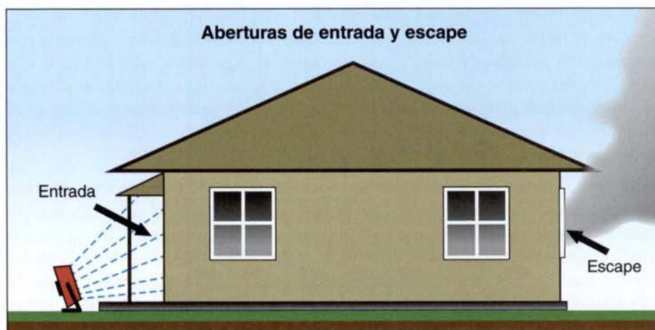
Imagen 11.18 Ejemplos de ubicaciones de aberturas de entrada y escape utilizadas en una operación de ventilación táctica.
