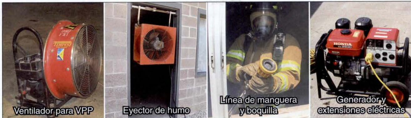
Imagen 11.14 Ejemplos de equipos de movimiento de aire comúnmente utilizados en operaciones de ventilación táctica.
