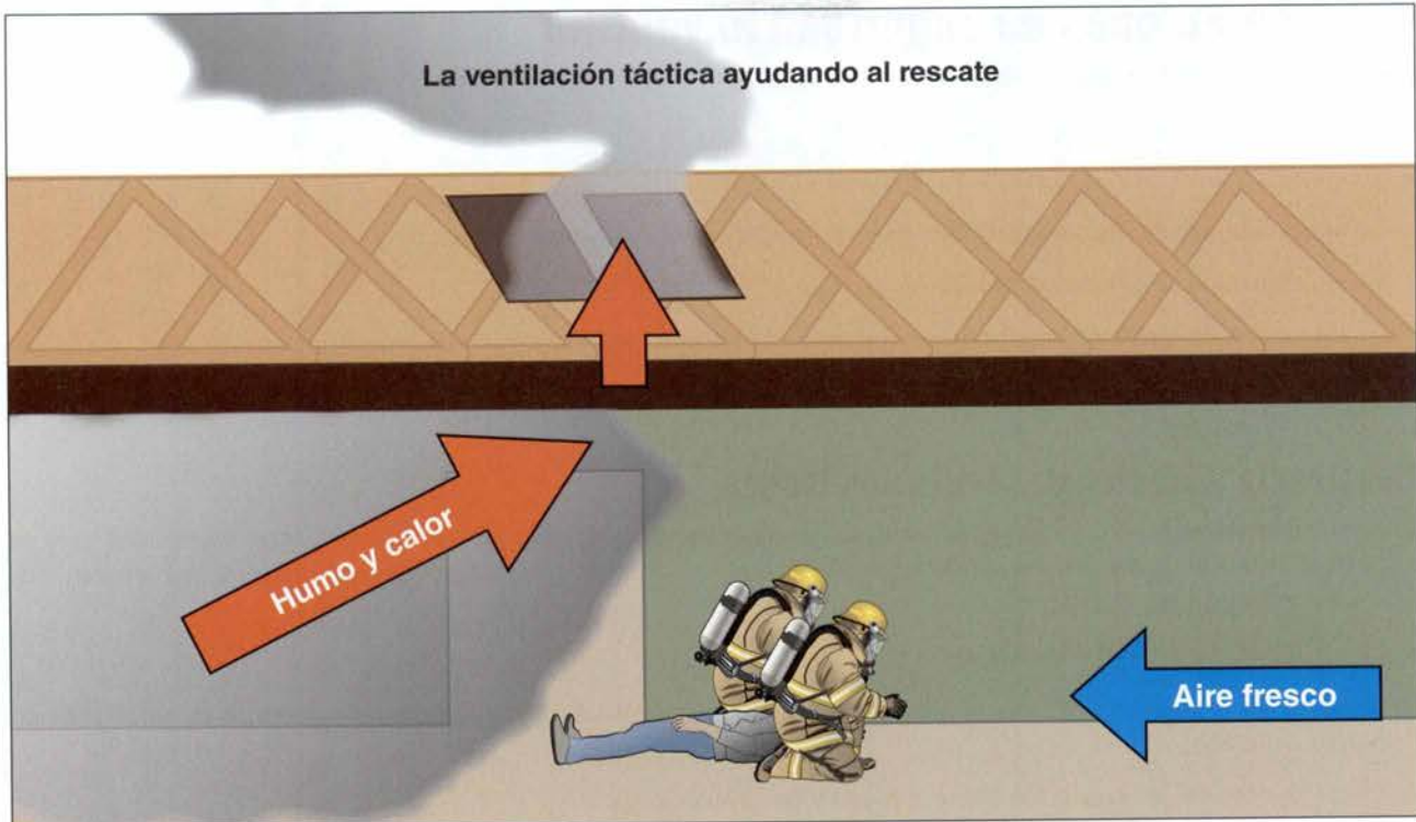
Imagen 11.9 La ventilación táctica puede crear áreas de salida sostenibles para ayudar en las operaciones de rescate.
