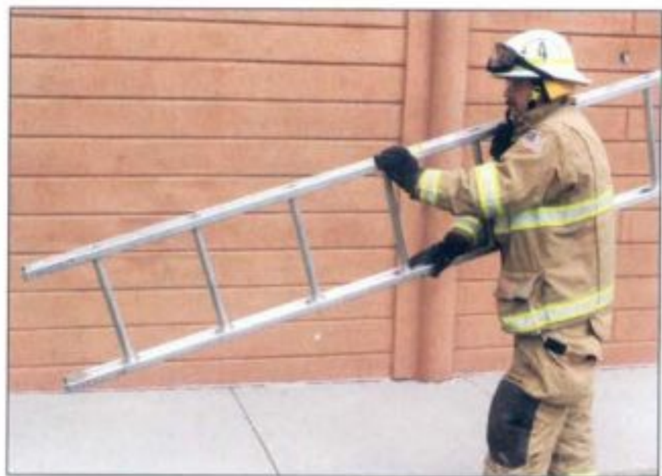
Imagen 8.19 Las escaleras deberían ser llevadas con el extremo inferior hacia adelante. Cortesía de Shad Cooper/Sublette County Unified Fire.
