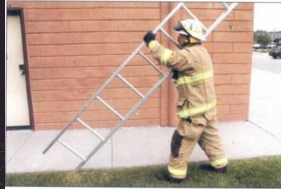
Imagen 8.24 Bombero que coloca la zapata de una escalera en el suelo y en el punto donde se levantará la escalera. Cortesía de Shad Cooper/Sublette County Unified Fire.
