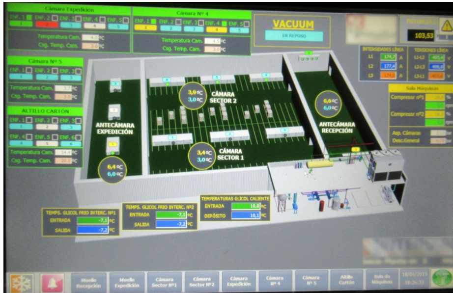
Programa de control que se puede visualizar en la sala de máquinas y de forma remota en un ordenador o un teléfono móvil. Foto. C.Artero
