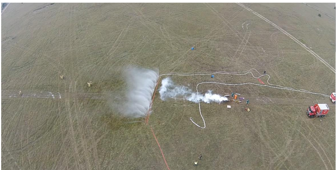
Fuga de amoniaco en espacio abierto (arriba) y misma foto con cortina de protección de agua (abajo). Fuente: Kernhannes
