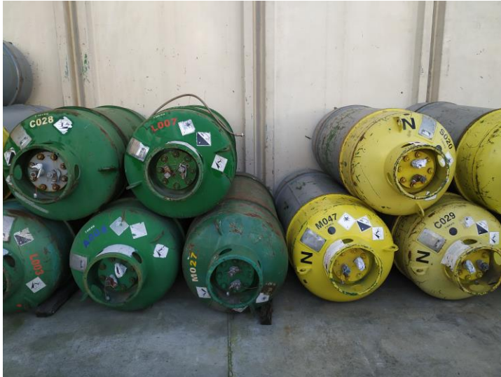
Botellones coloreados conforme a EN 1089 y antiguo RD. Foto: M.Albaladejo
