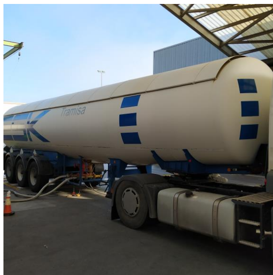
Cisterna con parasol realizando operaciones de descarga. Foto; M.Albaladejo
