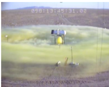
Fuga de Amoniaco (dcha) y cloro (izda)
