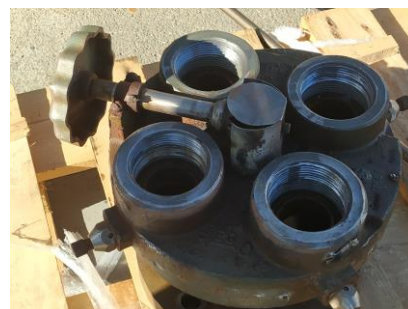
Dispositivo soporte multiválvulas de seguridad para recipiente de NH 3 . Foto: M.Albaladejo
