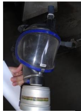
1. Armario con dos ERA completos 2. Mascara completa personal con filtro para amoniaco
