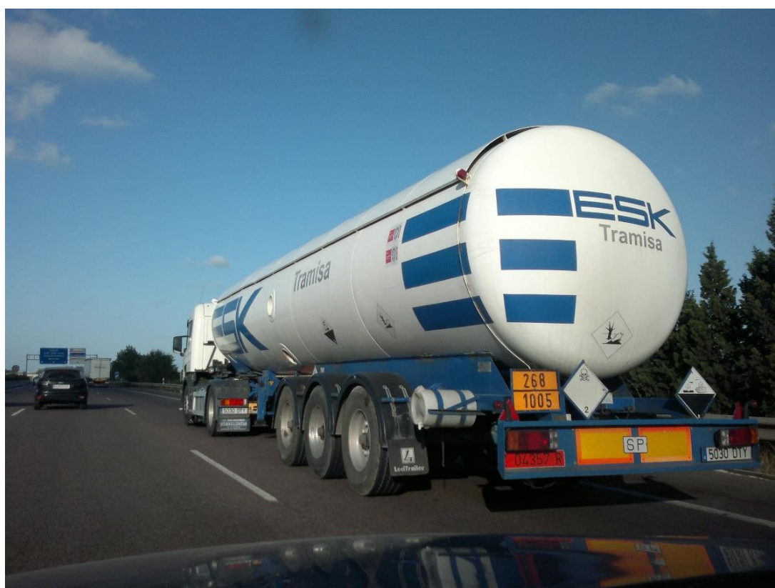
Cisterna de amoníaco anhidro.
