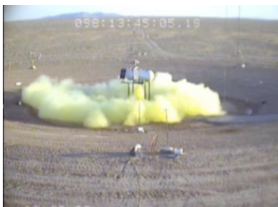
Fuga de Amoniaco (dcha) y cloro (izda)
