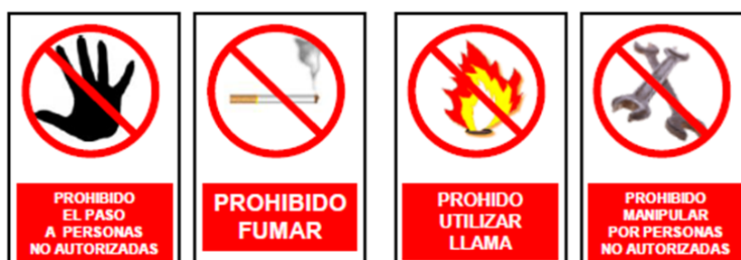
Carteles que debería haber en el exterior de la sala de máquinas
