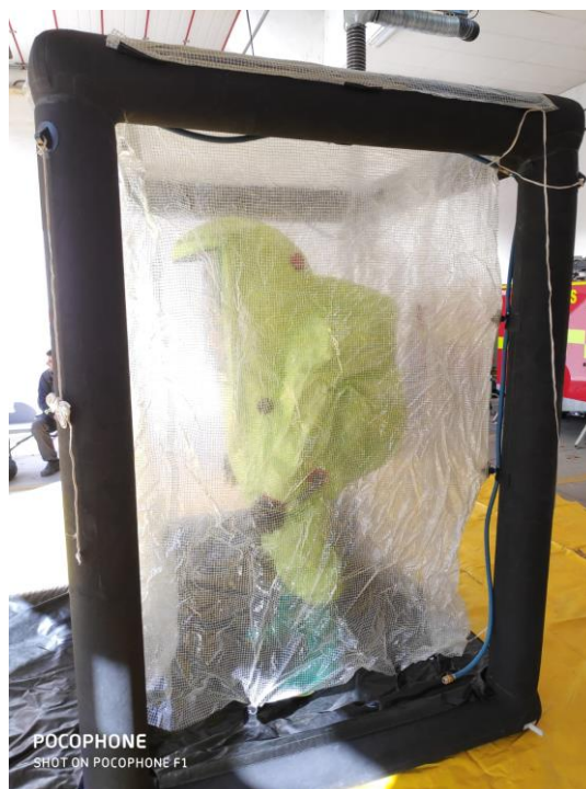
Ducha de descontaminación en la fase 2 del proceso de descontaminación
